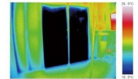
コールドドラフト現象が起り、床が冷やされて温度が下がり室内全体の温度低下がみられます。
